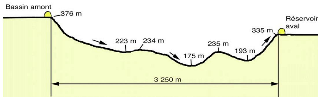
Fig. 1 - Coupe schématique du tracé du siphon de Pergame (150 av. J.-C.).
